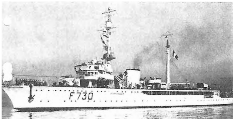
2 850 tonnes – 96,9 mètres de long – 14,8 mètres de large 2 moteurs Diesel de 3 900 chevaux – marche à 20 nœuds 3 canons de 120 mm – 4 canons de 40 mm – 4 canons de 20 mm 11 officiers et 173 hommes en temps de paix.
