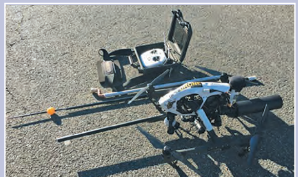
Fig. 9 : Drone lanceur de billes.
